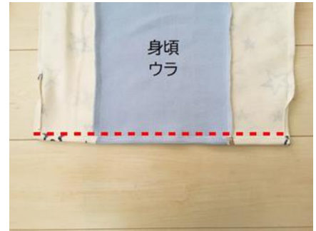
⑯裏側に1.5cm折り返し、端から2mmくらいのところをステッチで押さえます。 ※フリル付きの場合は一気に縫わず、フリルを避けながら数回に分けて縫うと良いです。
