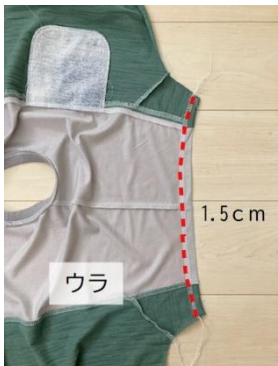
17. 半袖verは袖端に空ロックorジグザグミシンをかけ、1.5cm折り返してステッチを掛けます。 (長袖verは省略、工程18へ)
