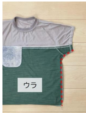
18. 身頃を中表にして袖先から裾までを縫い合わせ、端を処理します。 長袖verはこのあとに袖リブを縫い付けます。 ※レディースサイズ長袖は袖先の幅が大きいので少しギャザーを寄せてから袖リブを付けた方が良いです。
