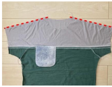
15. 前後身頃を中表に合わせ、肩を縫い合わせて端を処理します。
